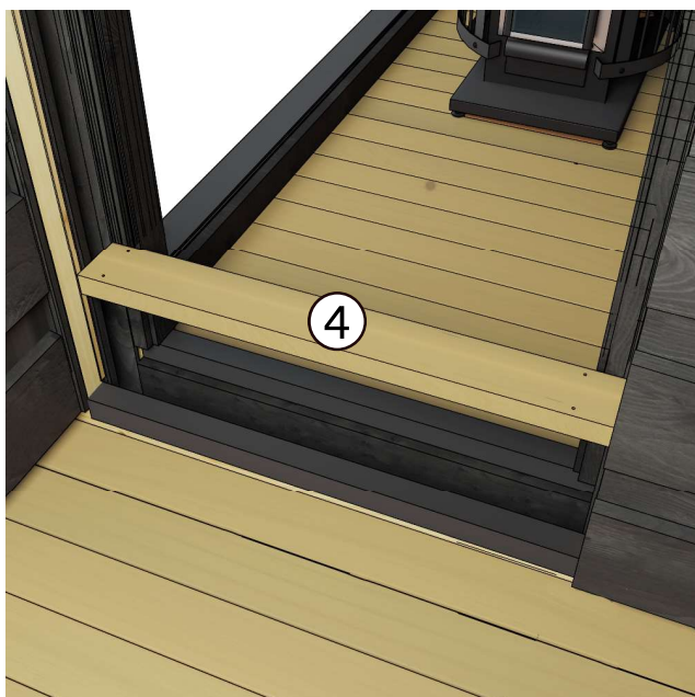
10. Placez la planche de seuil ( 4 ) entre le sauna et le vestiaire
