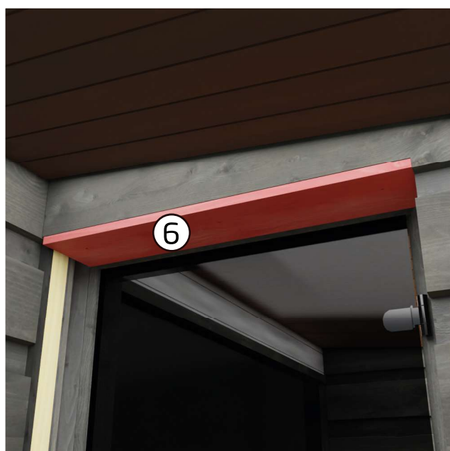
12. Recouvrez le haut de la porte avec le panneau de protection court (6). Le panneau de protection est placé contre les encadrements de porte du sauna.
