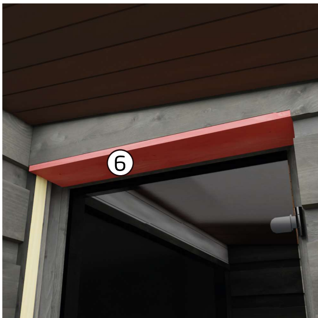
12. Fäst de långa smygbrädorna (6) i dörröppningens sidor. Placera smygbrädan mot bastuns dörrkarmar.
