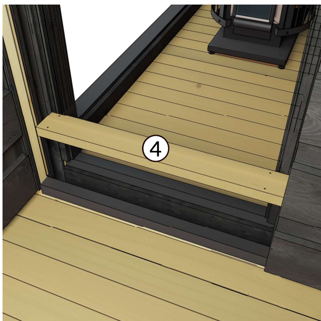
10. Plaats de drempel ( 4 ) tussen de sauna en de kleedkamer
